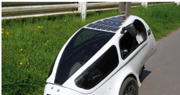
Педално-електрическа двуместна тандем триколка с фотоволтаични клетки на покрива и задната стена. завиваша с трите колела
